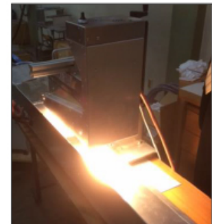
NIRを用いた銅ペーストの硬化 Curing with NIR アドフォス社製 NIR 126-250 (代理店: 松本金属工業(株)) Equipment: Adphos NIR 126-250
