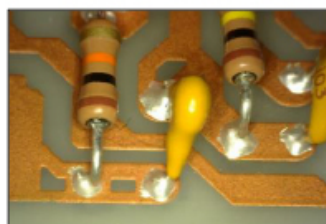
導電性接着剤による実装 Mounting with conductive adhesive
